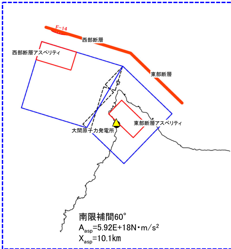
断層傾斜角60° の震源モデル
