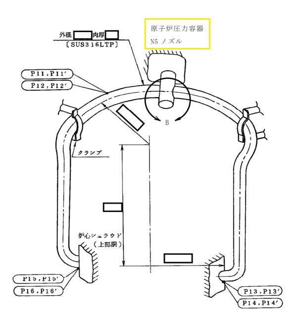
: 応力評価点 : 応力評価点
