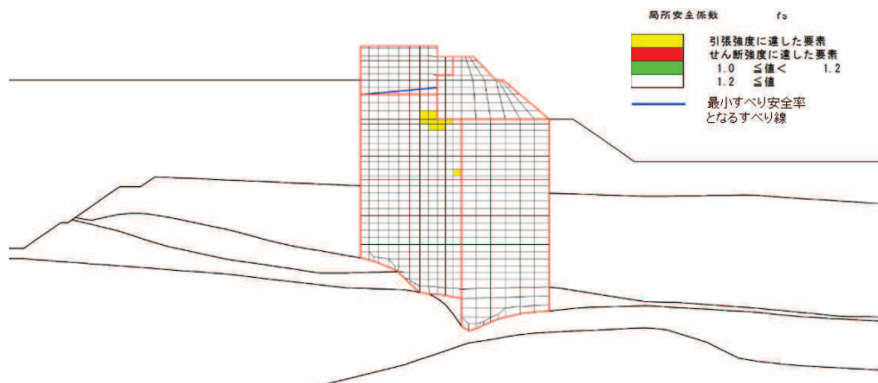
図 5.5-11 背面補強工の最小すべり安全率時刻における局所安全係数分布 (断面②, S s - D 2 ( - - ) , t=13.59, 液状化非考慮ケース②)
