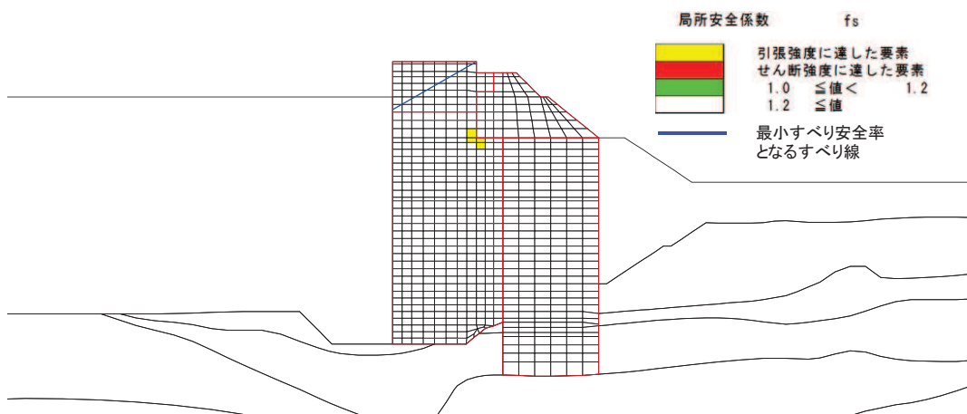
図 4.1-5 (1) 背面補強工の最小すべり安全率時刻における局所安全係数分布 (断面①, S s - F 3 (-+), t=28.66s) 解析ケース①: 基本ケース
