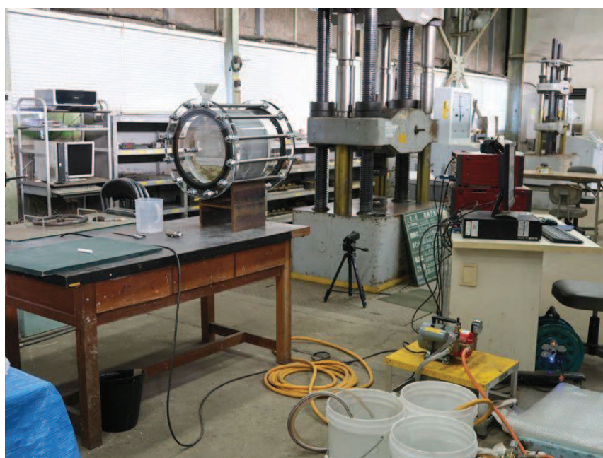
図 6.1.5-22 (2) 耐圧試験全体状況
