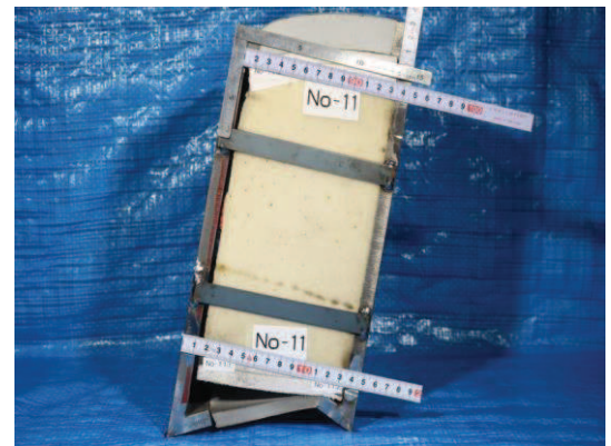
図3 ウレタンシリコーン目地変形試験状況 (試験体 No. 11, 伸び 4mm, せん断 30mm) (耐圧試験を実施するため, 変形状態を保持)
