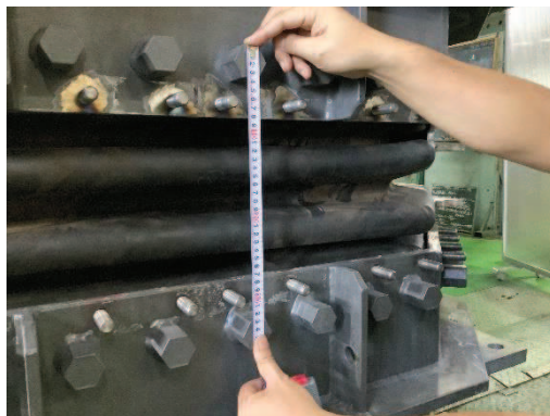
図 6.1.5-12(3) ゴムジョイント設置状況 (枠間距離計測)
