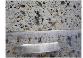
図1 模擬燃料デブリ (ドイツでの試験)
