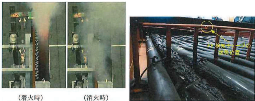
図 11 試験 V2 における発火・消火時の状態
