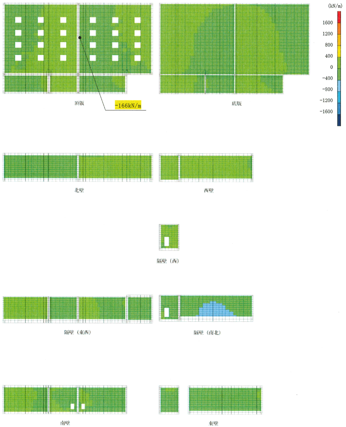
図 10-5 静的地震力載荷時の断面力分布図 (面内せん断力 (kN/m) : N_{x,y} )
