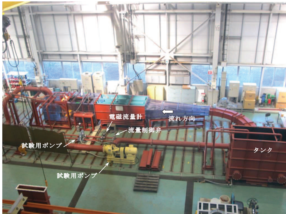
図 3-2(1) 試験装置全景
