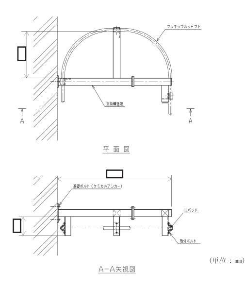
図 3-1 評価部位(取付ボルト,基礎ボルト)
