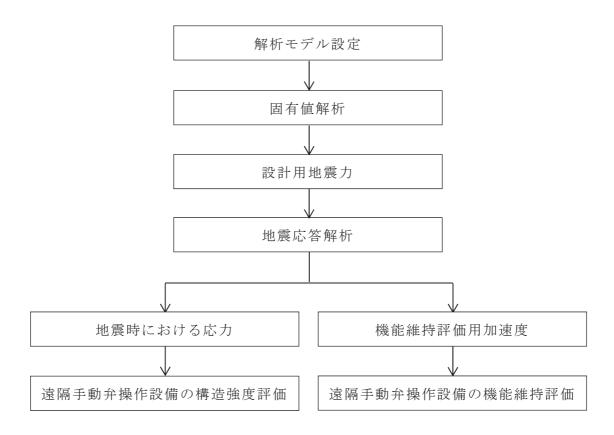
遠隔手動弁操作設備の耐震評価フローを図 2-1 に示す。
