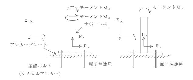
図 4-5 基礎ボルト部の概要
