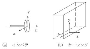
図 5-3 インペラ及びケーシング変位量の計算モデル
