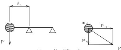
図 5-1 軸の計算モデル
