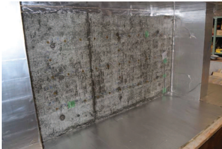
乾燥試験体[1]養生状況
