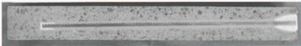
拡幅部親子ピット グラウトの注入状況（全体）
