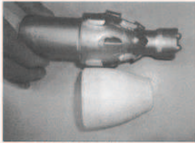
拡幅削孔用親子ビット
