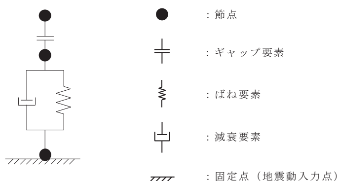
図 1-4 クレーン車輪部の非線形要素図
