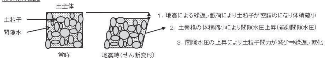
図 3.4-14 液状化の概念図
