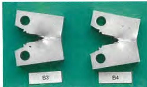
別紙 2-3 図 試験片写真 (初期材 200°C試験)
