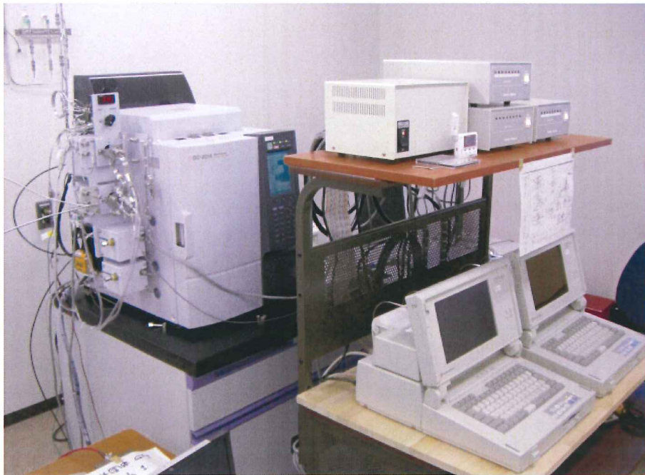
図 3-8-7 ガスクロマトグラフ 2 (全クリプトン定量用)
