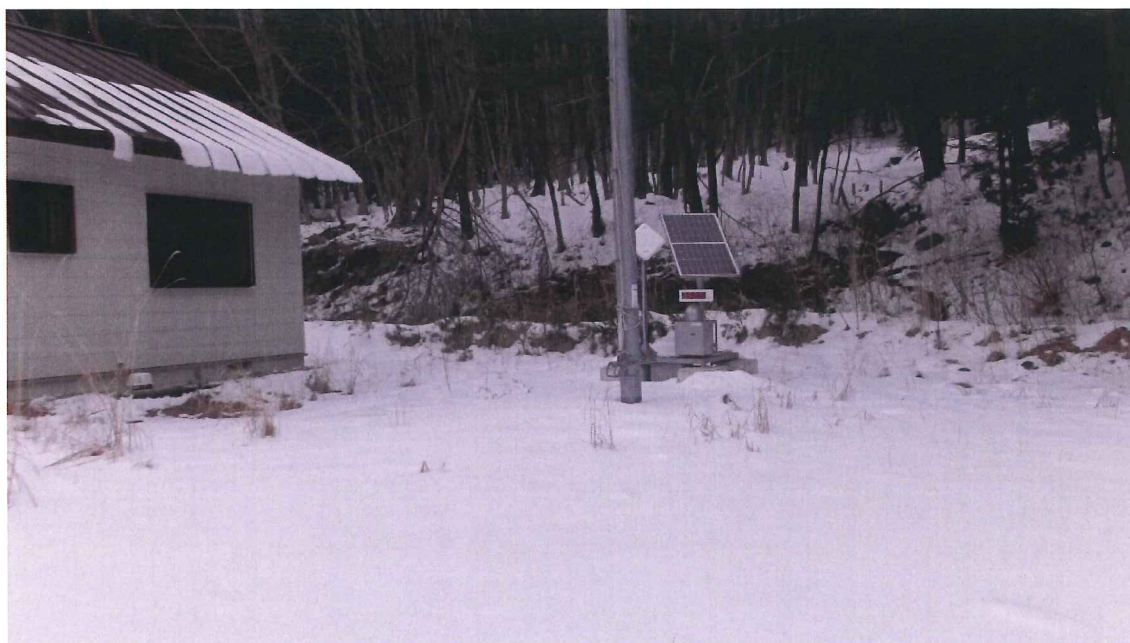
図 2-9-2-5 (2) 積雪による空間放射線量率下降時の様子 (手七郎集会所：平成 27 年 2 月 5 日撮影)
