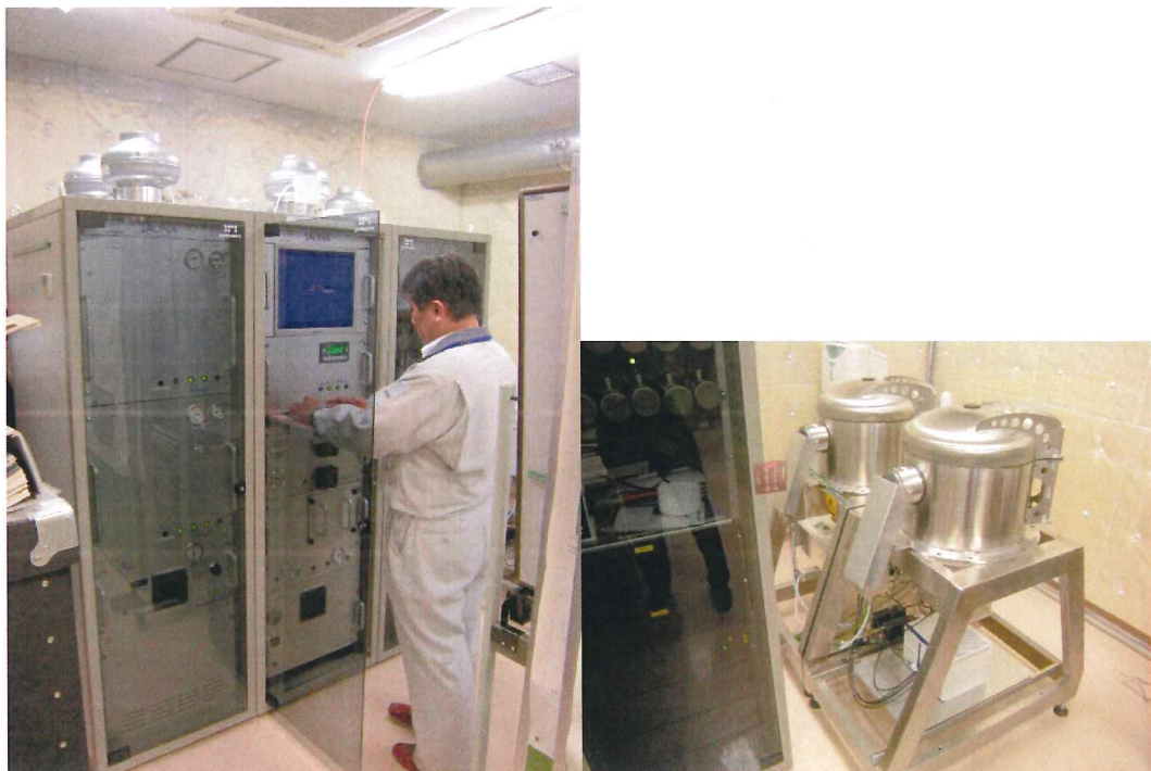
図2-8-7 自動放射性キセノン測定装置 (SAUNA-II) (左：ガス前処理-制御部、右：放射線計測部)
