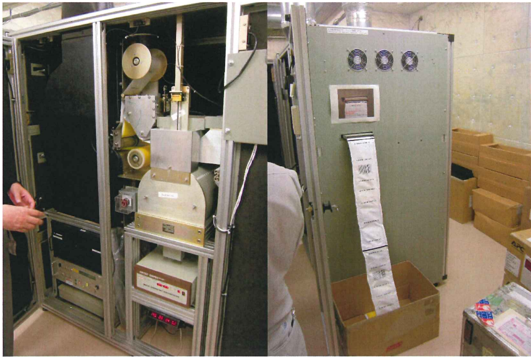
図2-8-6 全自動放射性粒子モニタリング装置 (RASA) (左：RASA内部、右：測定済み試料)
