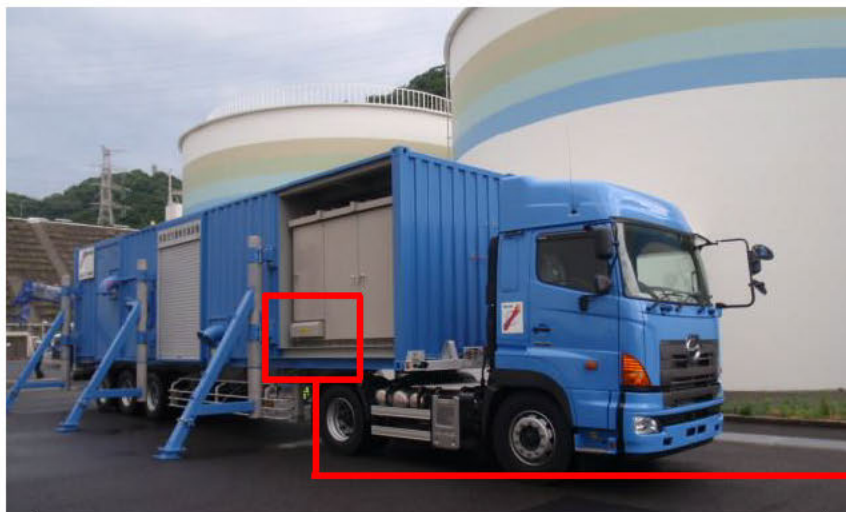
移動式代替熱交換設備 (除熱量：23MW/台，台数：2（予備1）)
