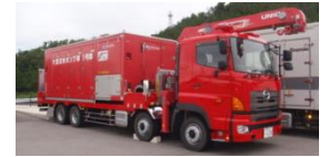
大型送水ポンプ車
