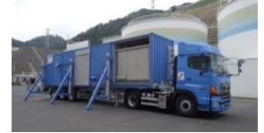
移動式代替熱交換設備
