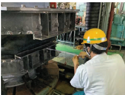
図 6.1.5-12(6) ゴムジョイント変形試験状況（伸び：150mm，せん断：350mm）
