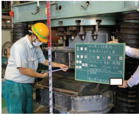
せん断方向距離計測状況
