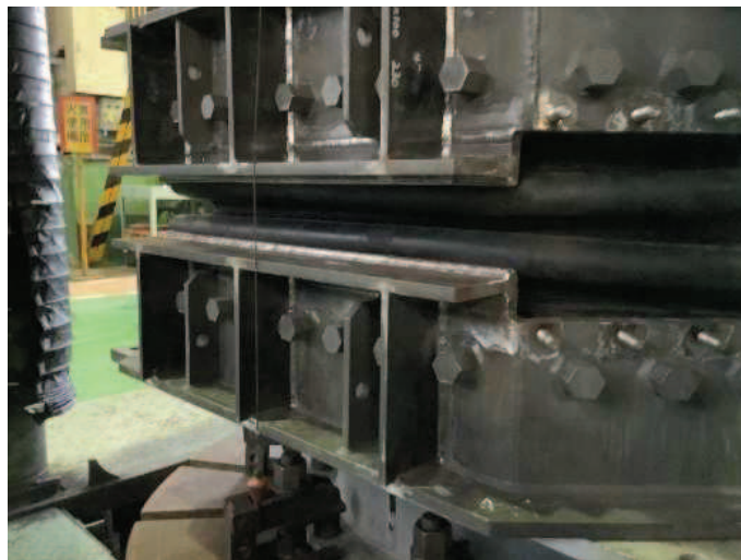
図 6.1.5-12(2) ゴムジョイント設置状況
