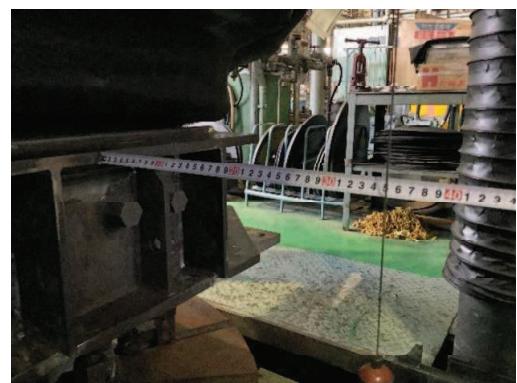
図 6.1.5-12(6) ゴムジョイント変形試験状況（伸び：150mm，せん断：350mm）
