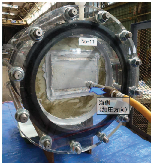
加圧前状況 (海側)
