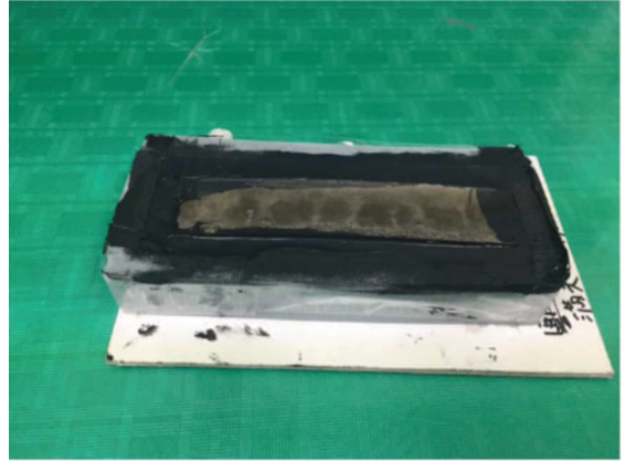
シリコーン材を2成分アルコール型シーラントでサポート
