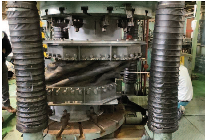
図 6.1.5-12(5) 変形試験全体状況（伸び 150mm，せん断 350mm，水圧 0MPa）
