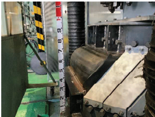
加圧状況 (漏えい無し)
