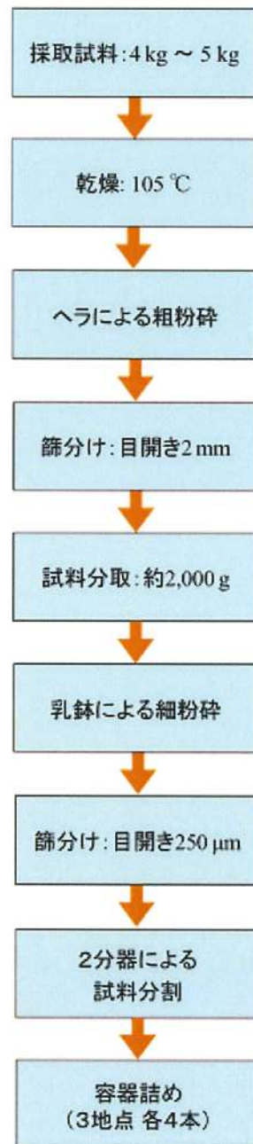
図 2-4 海底土試料の調製フロー
