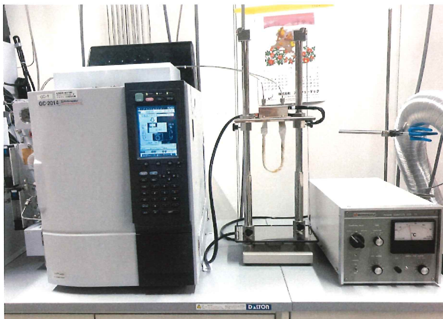
図 3-8-5 ガスクロマトグラフ1 (クリプトン粗分離用)
