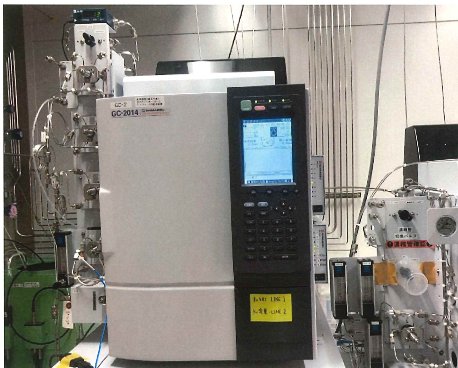
図 3-8-7 ガスクロマトグラフ 2 (分離・精製及び精密分析用)
