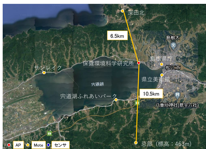
図 33 中継局の設置箇所。深田北は島根原発近くのモニタリングポスト向けを想定し、忌部は山間部にある集落への通信を想定している。
