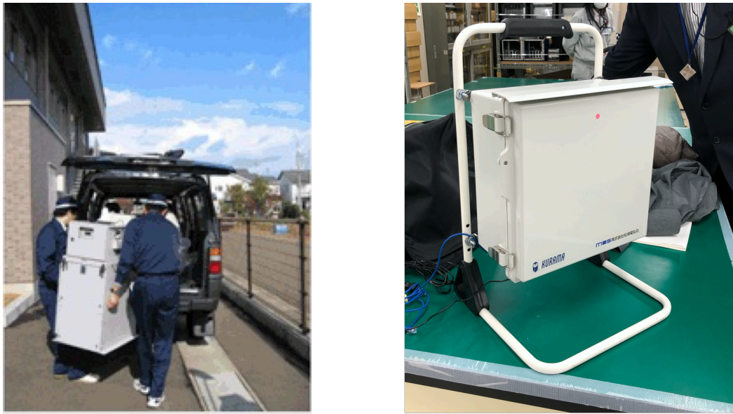
図9 (左) 従来の可搬型モニタリングポストの運搬の様子(新潟県 原子力防災訓練 Web ページより [13]) (右) 今回開発した可搬型モニタリングポスト試作機。片手で容易に運べる小型軽量化を実現している。
