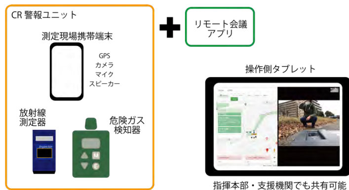
図 4-4 CR 警報ユニットとリモート会議アプリ 遠隔地で現地の被災者と通話ができる。
