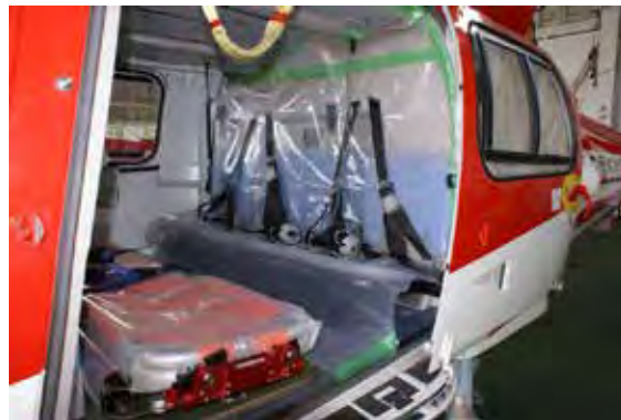
図 22. ヘリコプター壁の養生
