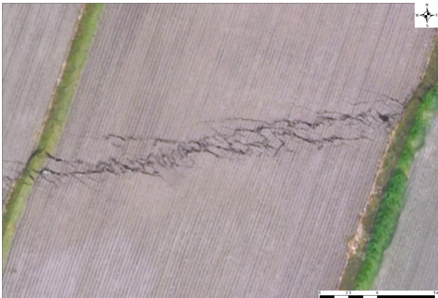
図 2.2.54 地表地震断層検討範囲拡大図 稲の刈り取り跡が線状に読み取れる
