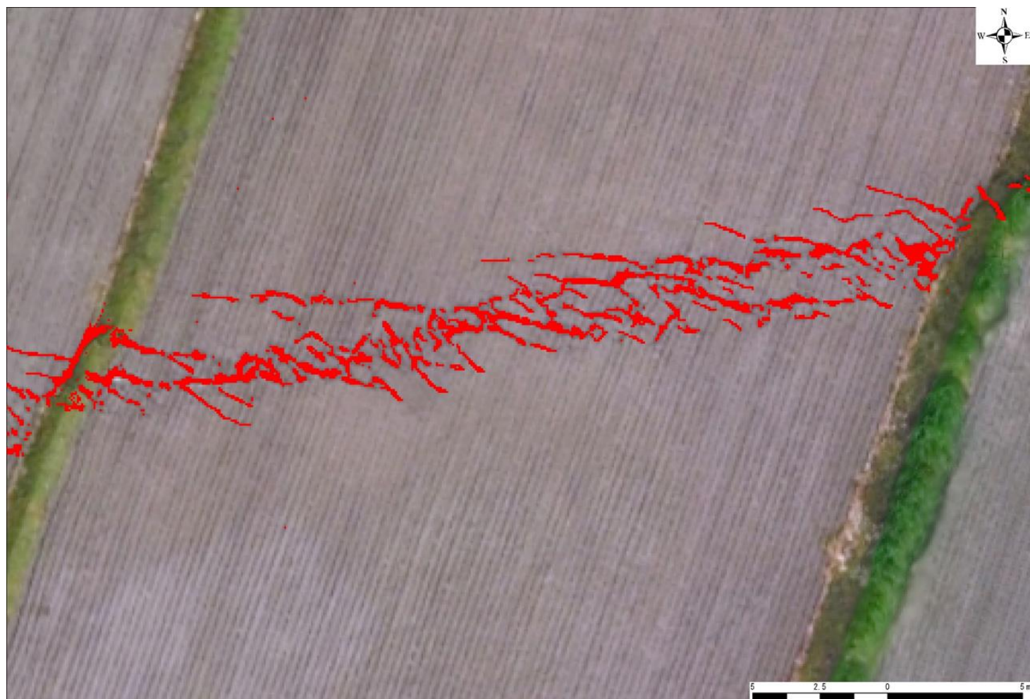
図 2.2.55 地表地震断層の画像をカラー調整により割れ目を抽出
