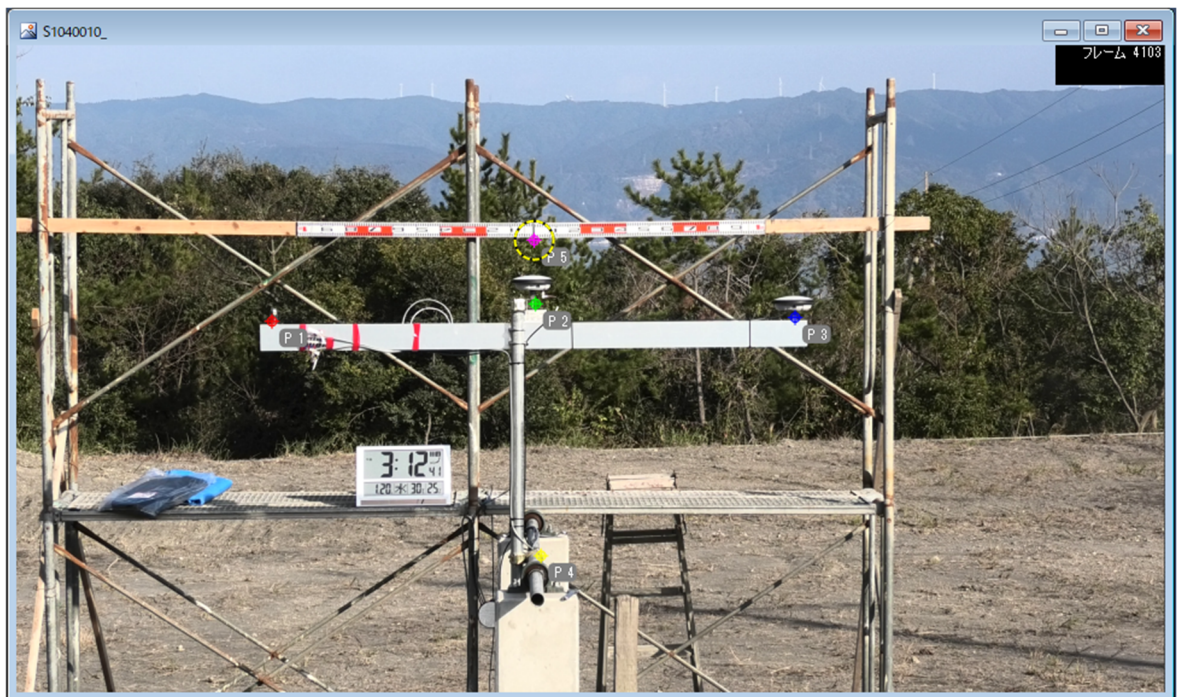
図 2-2-4-13. 実験 3 10W_20Hz_1 画像解析時マーカー設定
