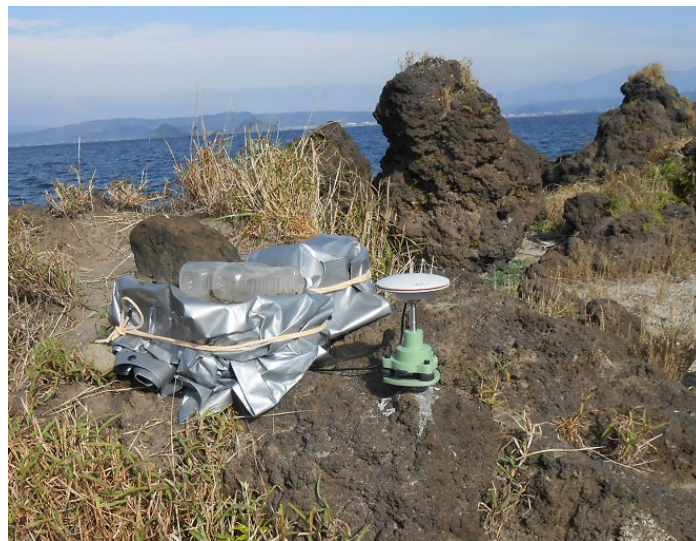
図 2-1-1-12 中之島 (NAKN) における GNSS キャンペーン観測の機器設置状況
