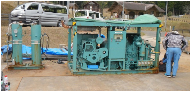
図 1-2-8. 高圧コンプレッサとマニホールド。右高圧コンプレッサ（三和鉄工所製 4S50A-15M 120m 3 /h, 15 MPa）、左マニホールド（100L）。
