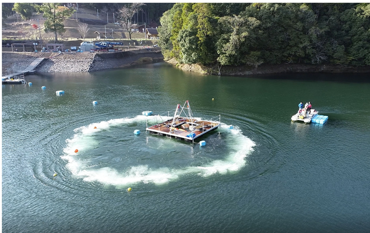
図 1-2-19. エアガン発振作業の全容（12月12日）。中央にクラスタエアガンを懸架したポンツーン、左奥の岸に高圧コンプレッサと現場本部が位置している。ポンツーン右側は作業船。
