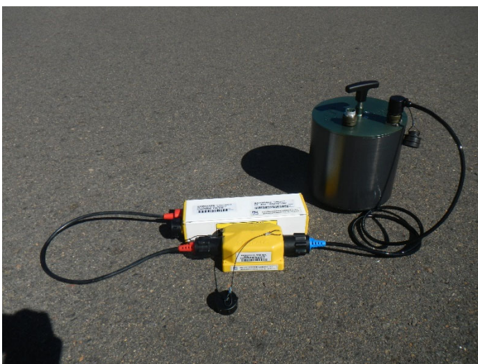
図 1-2-17. 地表観測点機材。白色機材はバッテリー、黄色機材は記録装置 GSR-3LF、濃緑色の円筒形機材は地表用 3 成分地震計 GS-1LF。
