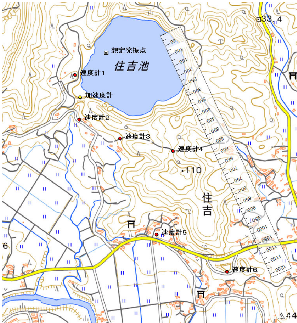
図 1-2-12. 住吉池測線の展開。速度計 1～6 観測点はそれぞれ観測点 SUM1～6 に対応し、加速度計観測点は SUMK1 に対応する。
