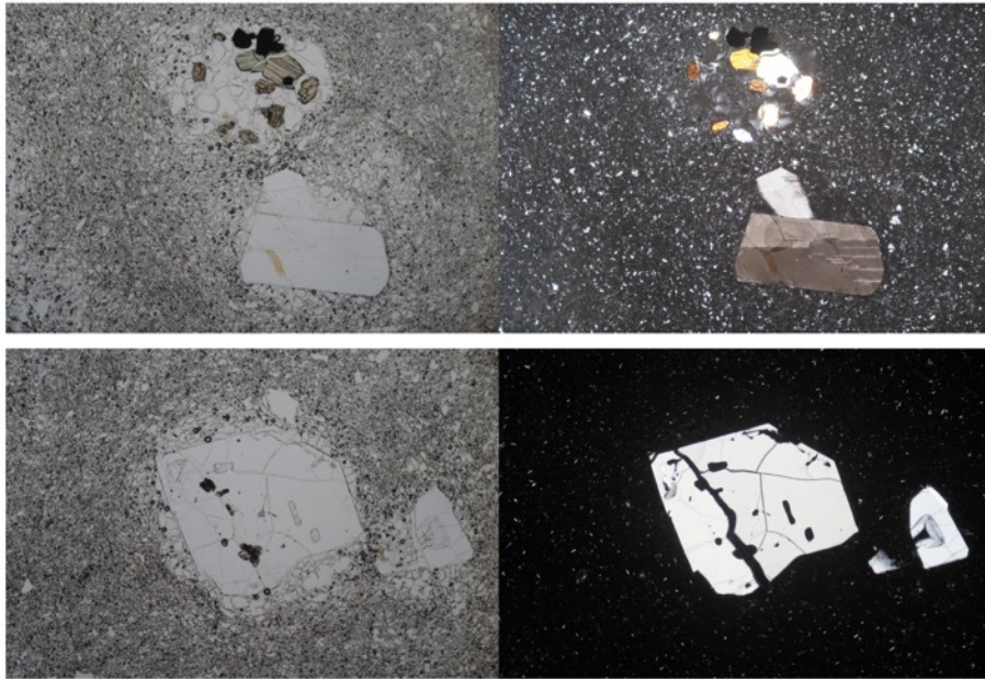
図 2.4-3. CP タイプの薄片写真（各写真の横幅は 6mm）.
