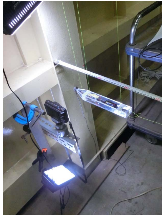
(b) ロードセル計測
