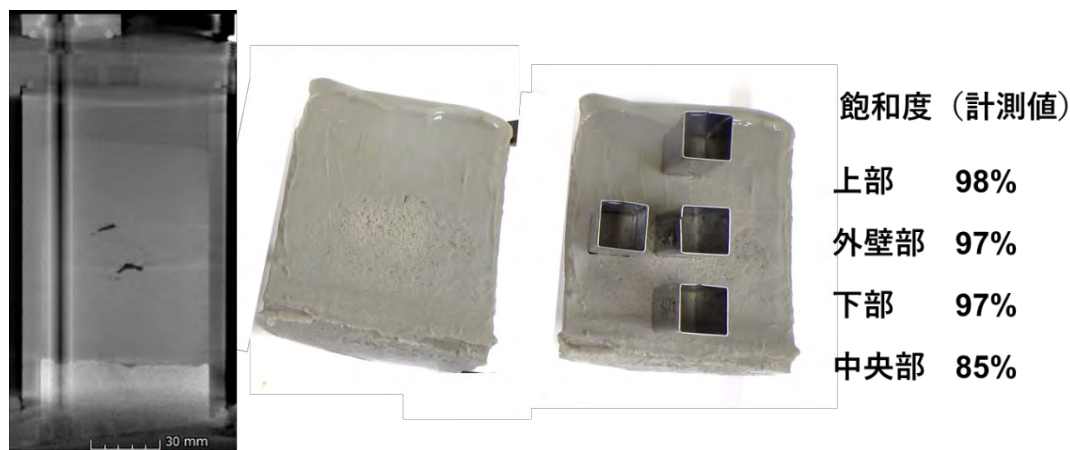
図 3-21 0.3 MPa の水圧条件下で膨潤させたブロックの CT 画像、切断面と各部位の飽和度
