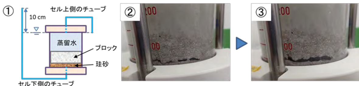
図 3-23 ブロックが浮き上がる様子 (8)
