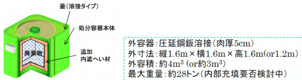
図 4.2-3 鋼製角型容器の概要 (28)
