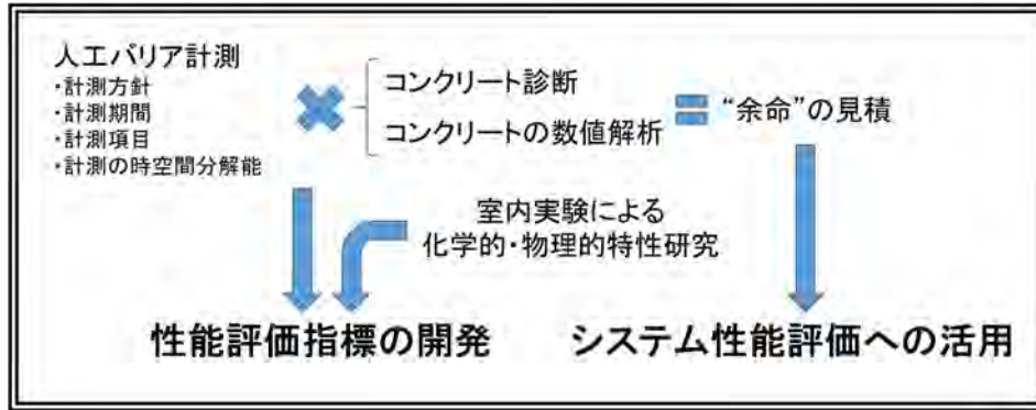
図 1.3-36 モニタリング技術を含めたセメント系人工バリア性能評価の概念
