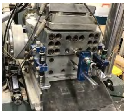
(e) せん断箱設置状況
