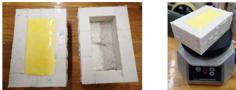
図 1.2.2.1-4 左：シリコンに石膏を流し込んだ様子，右：振盪器による石膏内の気泡の除去
