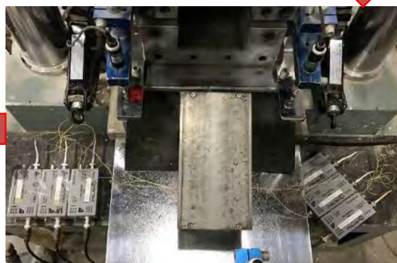
(d) せん断箱と AE システムとの連結の様子
