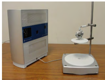
図 1.2.2.1-6 3D レーザースキャナーによる不連続面の点群データの測定
