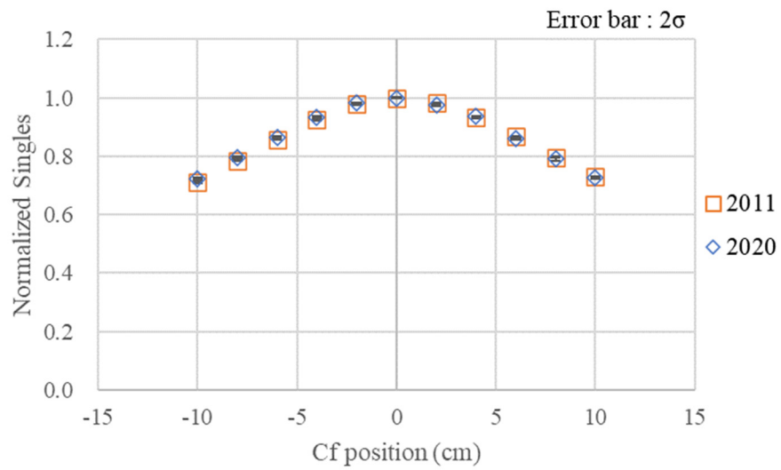
図 2.4.4-27 垂直方向の検出効率プロファイルの比較 (AFAS-P Top Fork 検出器)
