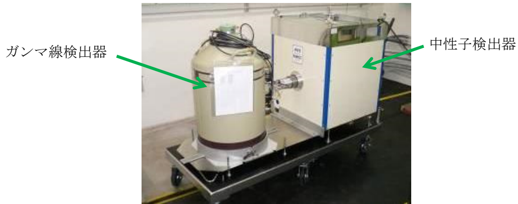
写真 1.1-2 AVIS の外観写真
