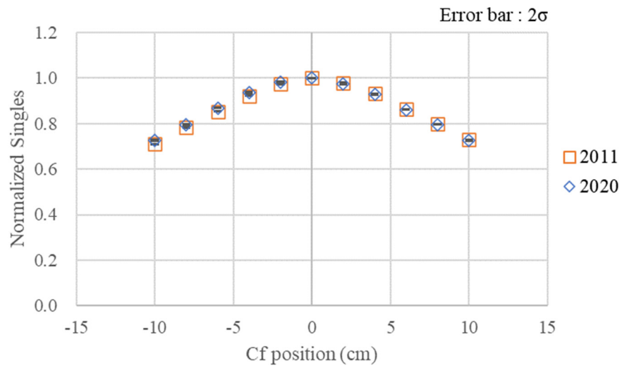
図 2.4.4-30 垂直方向の検出効率プロファイルの比較 (AFAS-P Bottom Fork 検出器)
