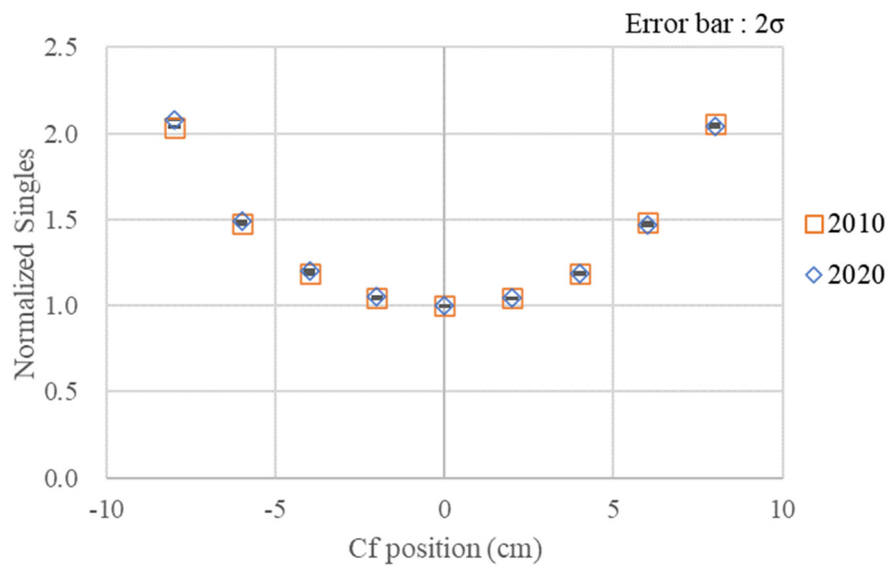
図 2.4.4-17 水平方向の検出効率プロファイルの比較 (AFAS-B Top Fork 検出器)
