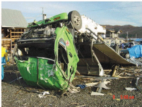
図37 竜巻による被災後の4tトラックの様子 (26)(30)
