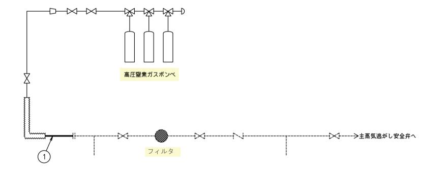
注記 \*:代替高圧窒素ガス供給系は2系統(A系,B系)で構成 され,1系統あたり高圧窒素ガスボンベを3本設置する。 本概略系統図では,1系統を記載。
