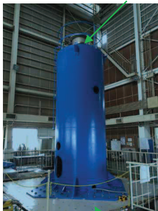
加振台 試験装置外観
