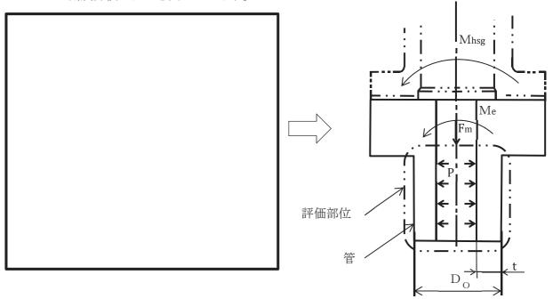
図 4-2 耐震評価モデル
