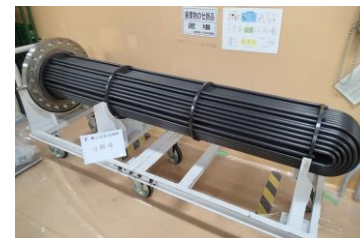
蒸気発生器の点検整備
