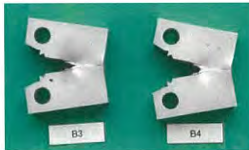
別紙 2-3 図 試験片写真 (初期材 200°C試験)
