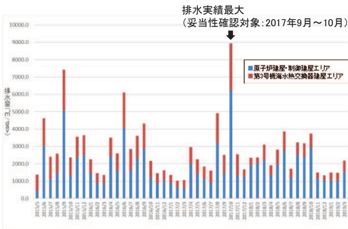
既設ポンプ排水実績(月別)
