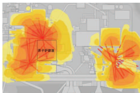
(b) 初期水位(通常の運転状態)からの水位上昇差分 (排水機能停止後25時間経過後の例)
