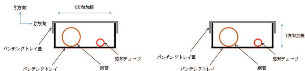
図 4-2 パンチングトレイ内断面図
