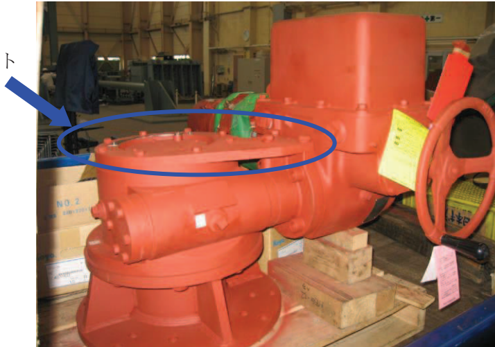
図 2.4-6 二次減速機付き電動弁駆動部（補強後）
