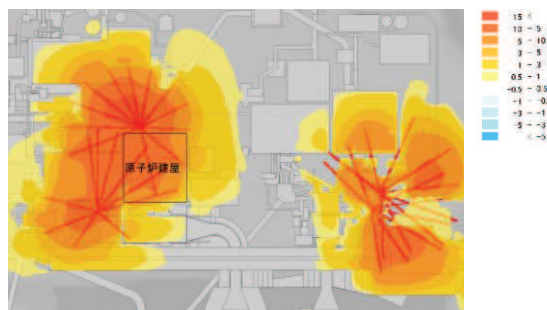
(b) 初期水位(通常の運転状態)からの水位上昇差分 (排水機能停止後25時間経過後の例)
