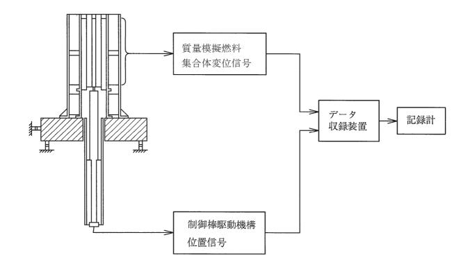
図 4-2 計測装置の概要
