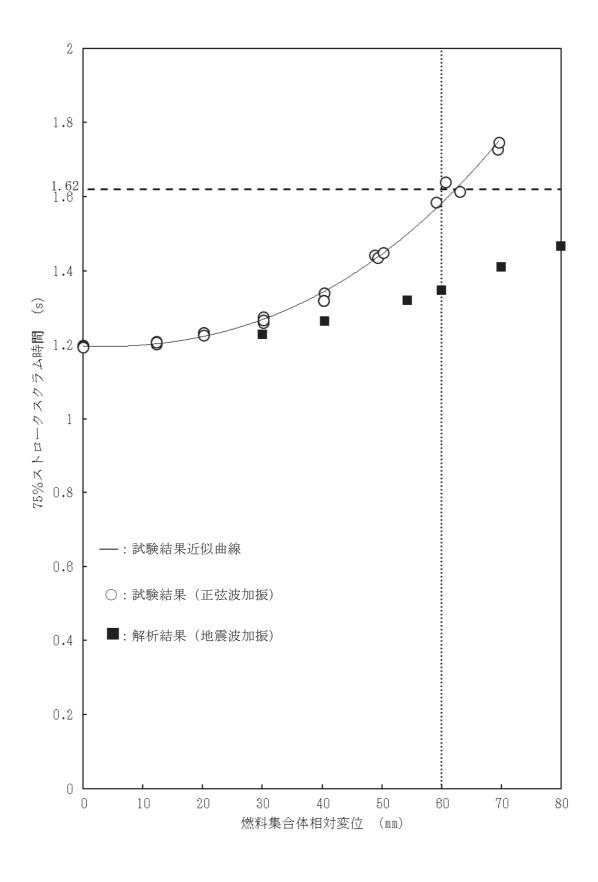
図 5-1 燃料集合体相対変位のスクラム時間に及ぼす影響
