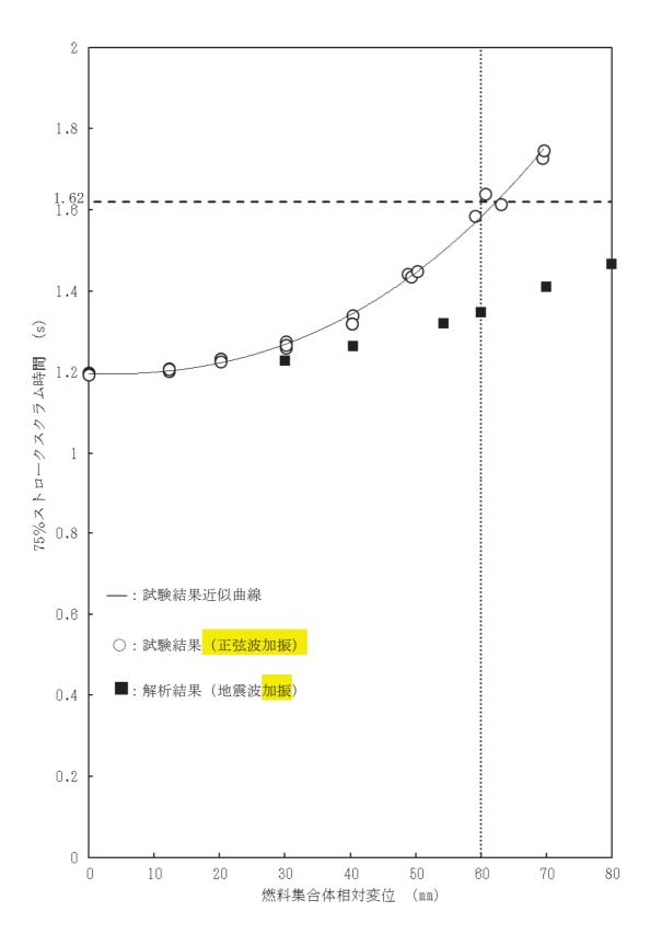
図 5-1 燃料集合体相対変位のスクラム時間に及ぼす影響 (制御棒挿入性解析よる解析結果)
