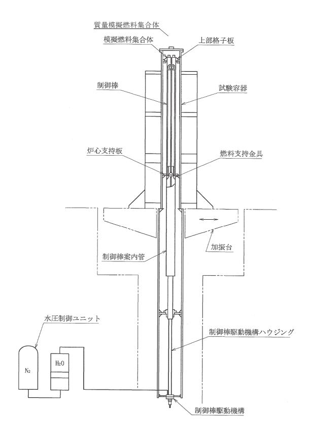
図 4-1 試験装置の概要
