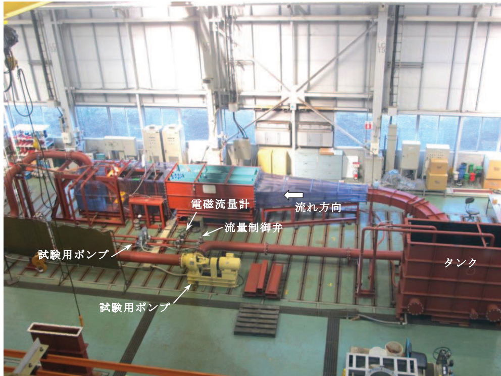
図 3-2(1) 試験装置全景
