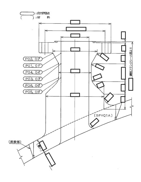
図 13-1 形状・寸法・材料・応力評価点 (単位:mm)
