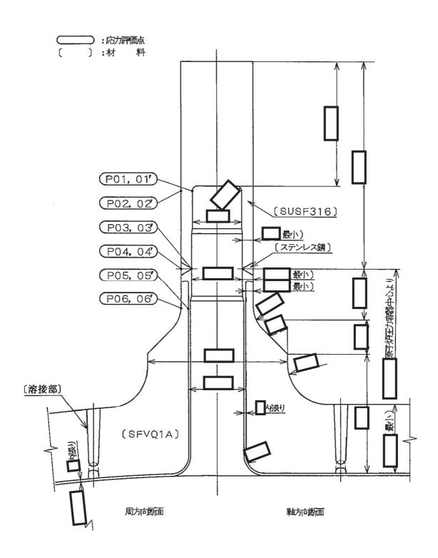
図 15-1 形状・寸法・材料・応力評価点 (単位:mm)
