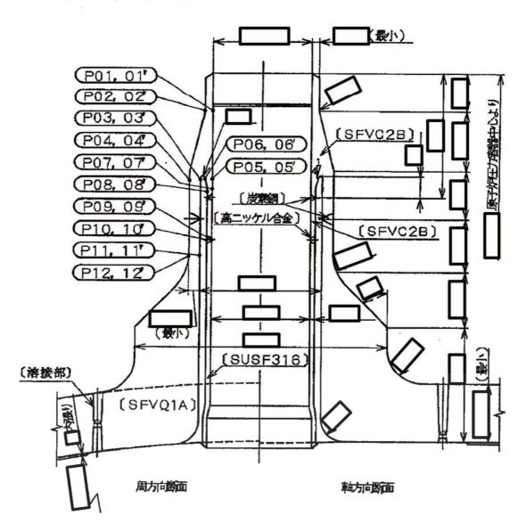
図 11-1 形状・寸法・材料・応力評価点 (単位:mm)
