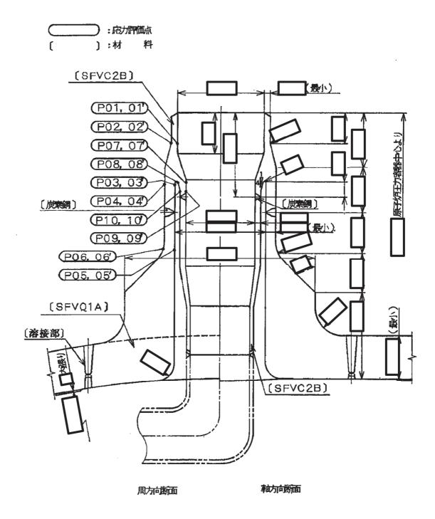
図 10-1 形状・寸法・材料・応力評価点 (単位:mm)
