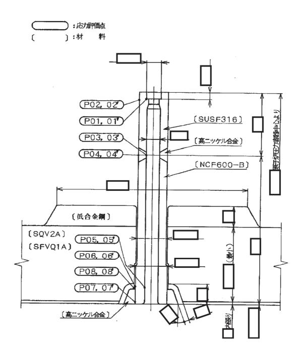
図 17-1(1) 形状・寸法・材料・応力評価点 (単位:mm) (計装ノズル (N12 及び N13))
