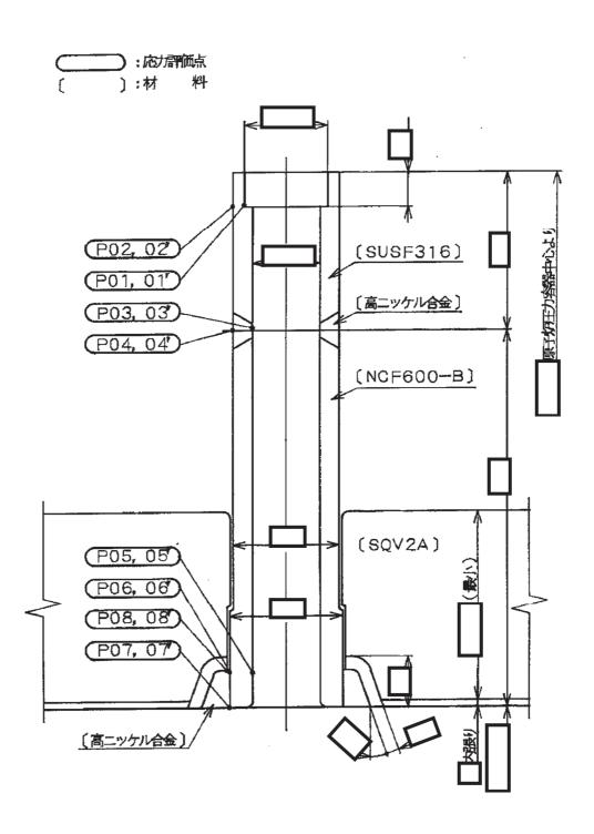
図 17-1(2) 形状・寸法・材料・応力評価点 (単位:mm) (計装ノズル (N14))
