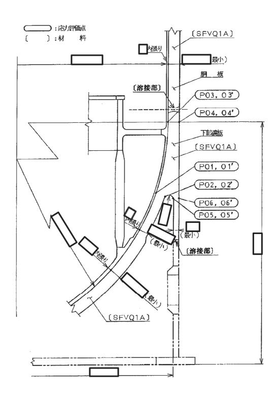
図 4-1 形状・寸法・材料・応力評価点 (単位:mm)
