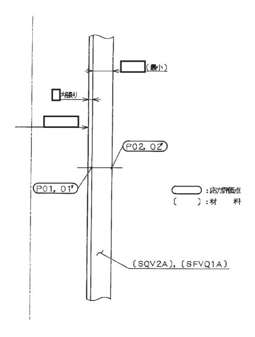
図 2-1 形状・寸法・材料・応力評価点 (単位:mm)
