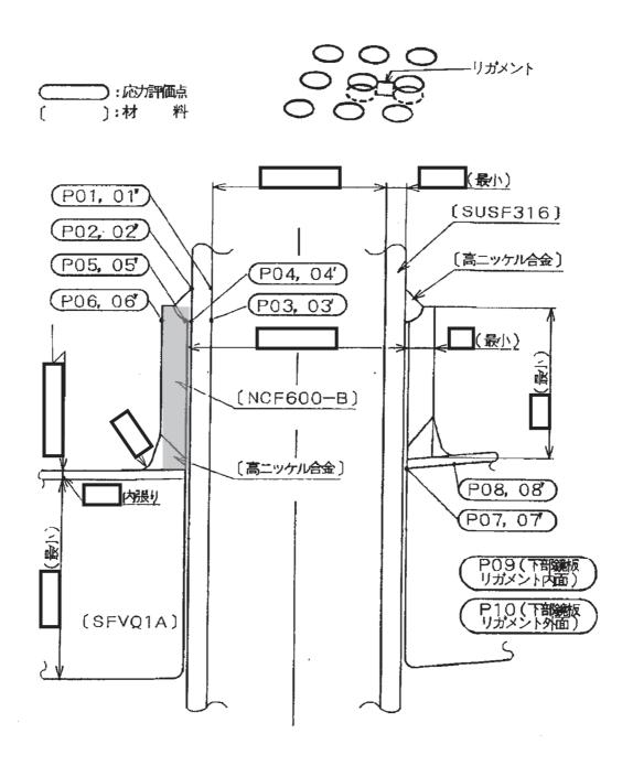
図 5-1 形状・寸法・材料・応力評価点 (単位:mm)
