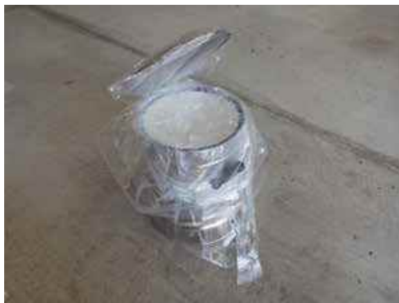
図 12. 搭載器材の養生
