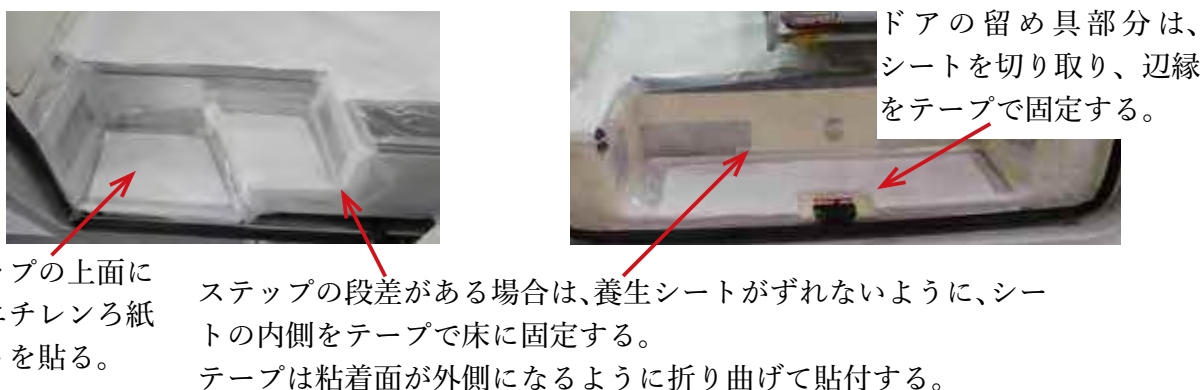
図 3. ステップ部分の養生
