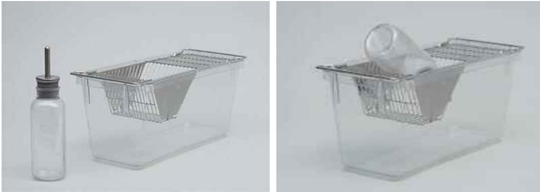
図 2.3-5. 飼育ケージ KN-60105-T。給水瓶を右図のように装着すると活性炭含浸フィルタで覆うことができないため、トランスポートアガーを用いた。
