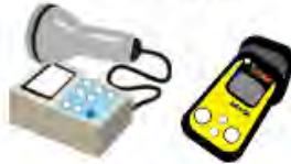
GM計数管式 サーベイメーター \beta ( \gamma ) 線を測定
