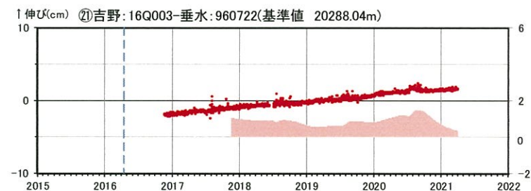
始良 GNSS連続観測による基線長変化(2015年06月11日～2021年03月31日)
