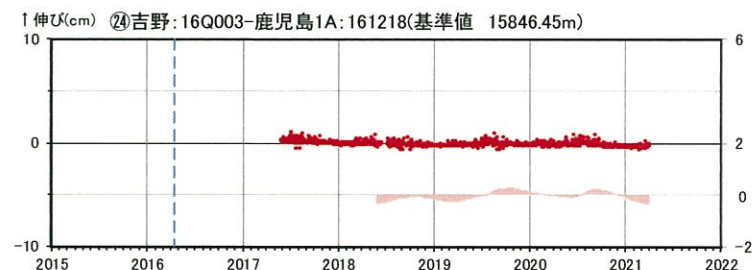
始良 GNSS連続観測による基線長変化(2015年06月11日～2021年03月31日)
