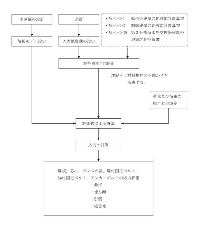
図 2-4 水密扉の強度評価フロー
